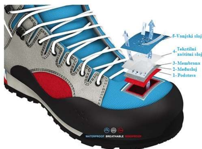
Slika 4. Laminati Sympatex® za vanjske aktivnosti, trekning i sportsku obuću [19]
