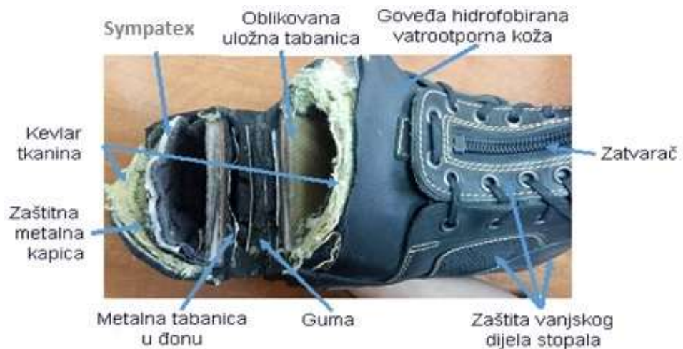
Slika 6. Čizma za šumare prikazana po slojevima
