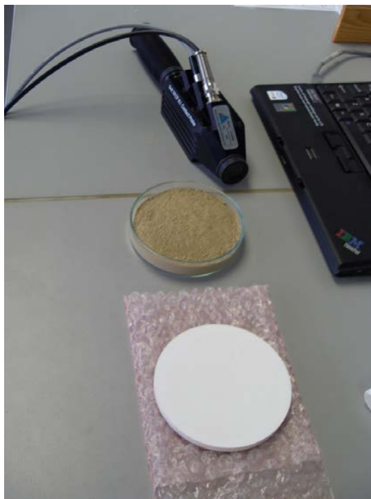
Slika 9. Kalibracija sa NIST-traceable kalibracijskom pločom poznate stabilne reflektancije
