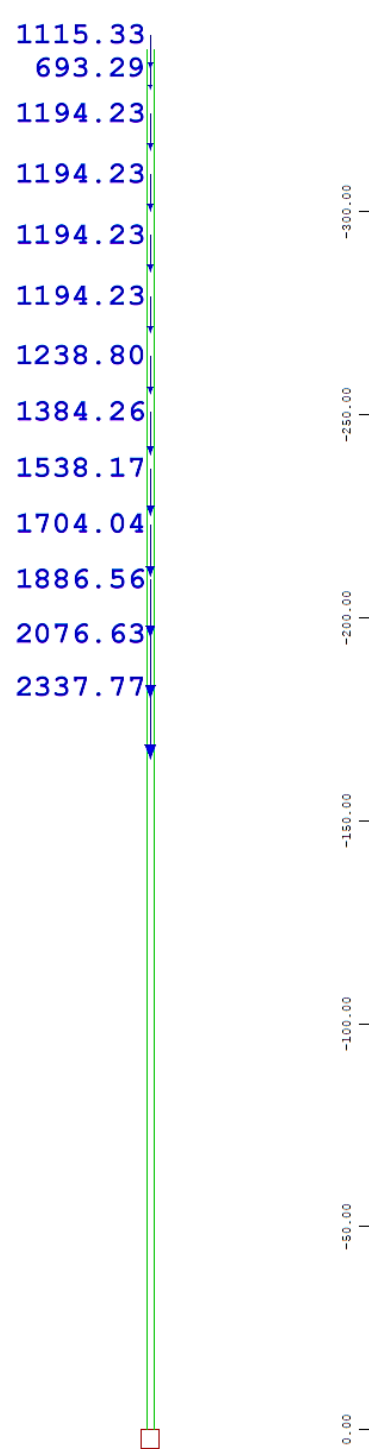
Slika 6.3 Prikaz dodatnog stalnog opterećenja [kN] za postojeće stanje u Sofistiku
