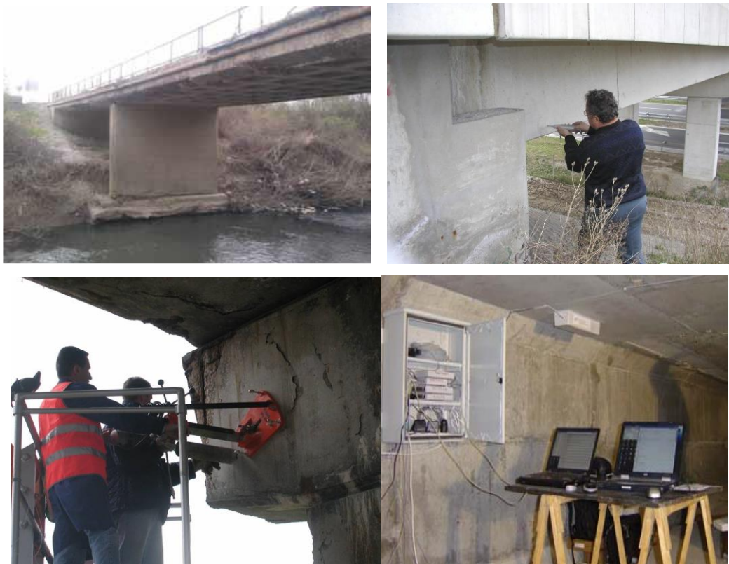
Slika 20. Glavni pristupi otkrivanju oštećenja: vizualni pregled, nerazorno ispitivanje, sondiranje i monitoring
