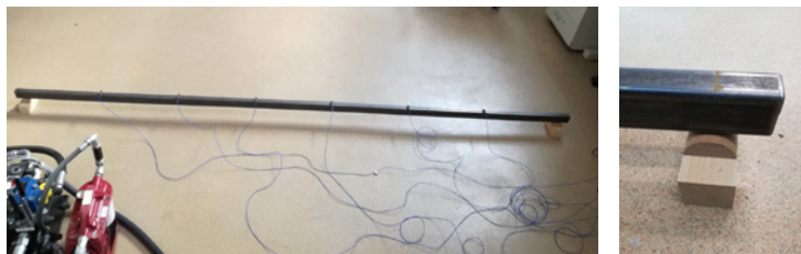
Slika 2. Postavka grede za ispitivanja (model D) i prikaz oslonca
