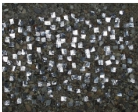
Slika 5. Ispitni postav koji se sastoji od objekta postavljenog ispod površine s nehomogenim pokrovom, a) skica postava, b) izgled površine.
