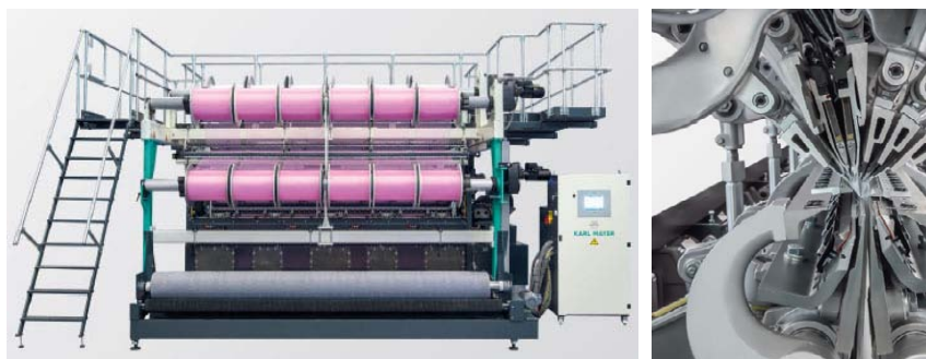
Sl.9 Osnovo prepletaći dvoiglenični stroj model RD 5/1 EL tvrtke Karl Mayer, Njemačka za izradu pletenih gornjišta obuće: a) stroj sa osnovom, b) položaj iglenica i polagala
