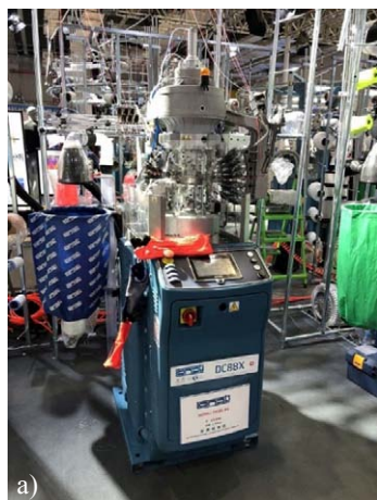
Sl.1 Čaraparski automat model DC88X tvrtke Lonati izrađuje pletivo za gornjište dječjih papuča i sličnih proizvoda: a) stroj u proizvodnji, b) modeli laganih papuča čija su gornjišta pletena i ugrađena u jednom komadu
