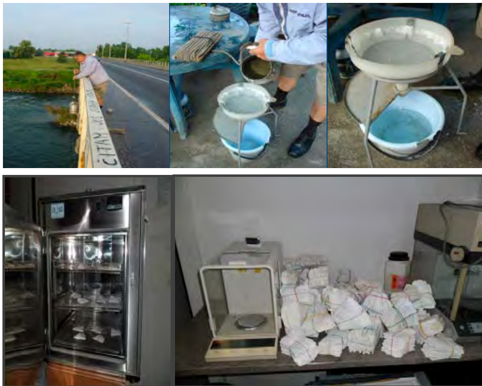
Slika 2. Uzimanje uzoraka vode za analizu suspendiranog nanosa te laboratorijska obrada dnevnih uzoraka filter papira pristiglih s terena
