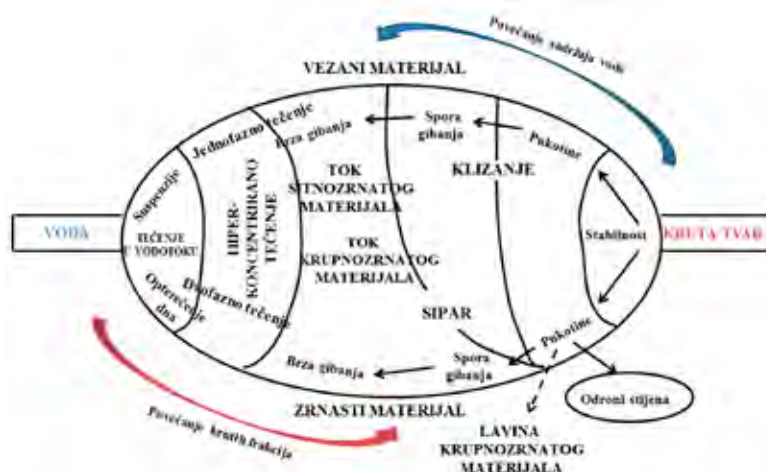
Slika 1. Klasifikacija gibanja mase kao funkcija krutih frakcija i tipa materijala, (modificirano prema Coussot i Meunier, 1995)
