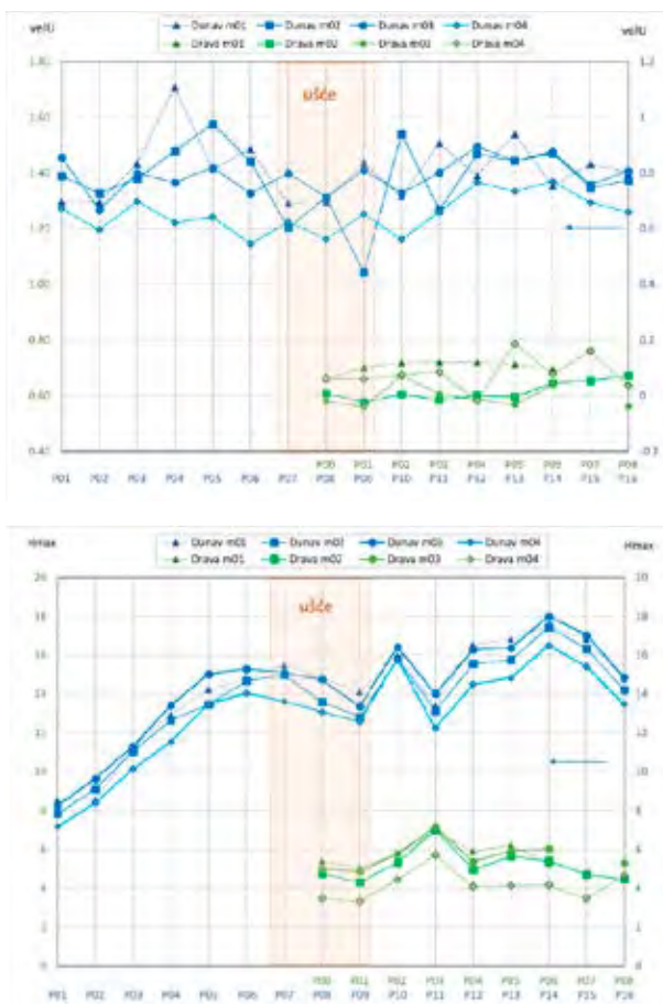
Slika 2. Raspored srednje brzine toka U (lijevo) i talvega (desno) za sva mjerenja duž dionice
