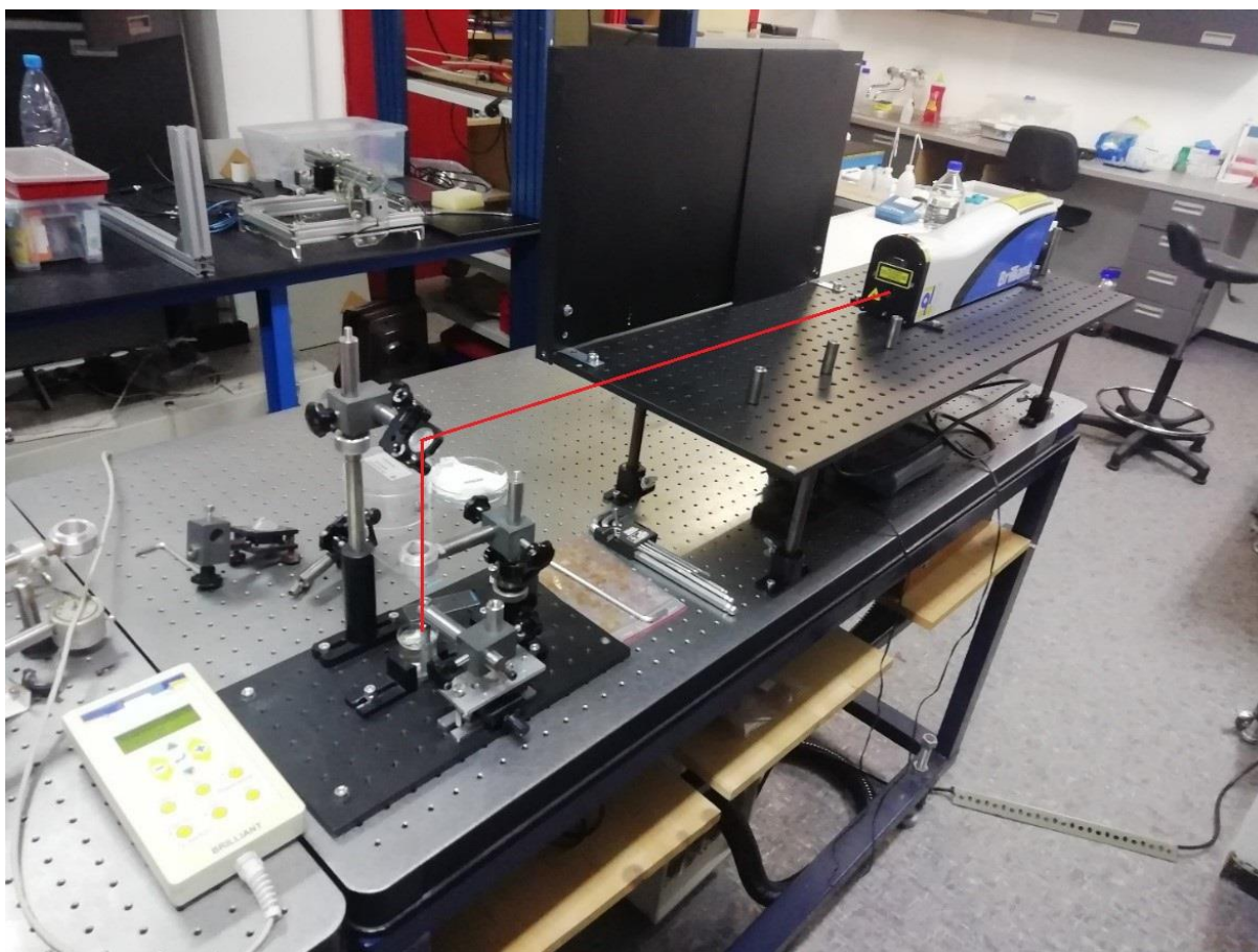
Slika 4 Eksperimentalni postav laserske ablacije u tekućini
