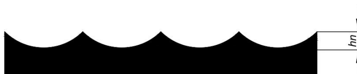
Teoretska visina neravnine kod površine nakon blanjanja
