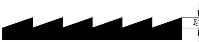
Teoretska visina neravnine kod površine nakon piljenja
