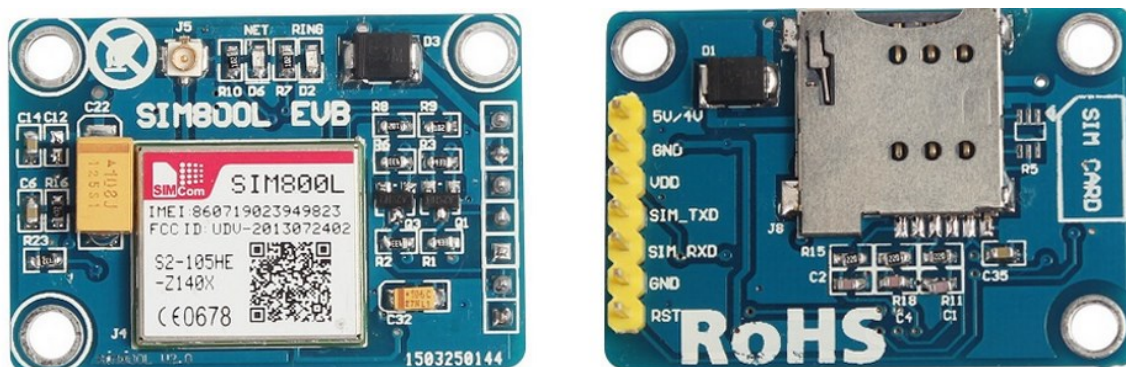
Slika 2.1 SIM800L EVB modul
