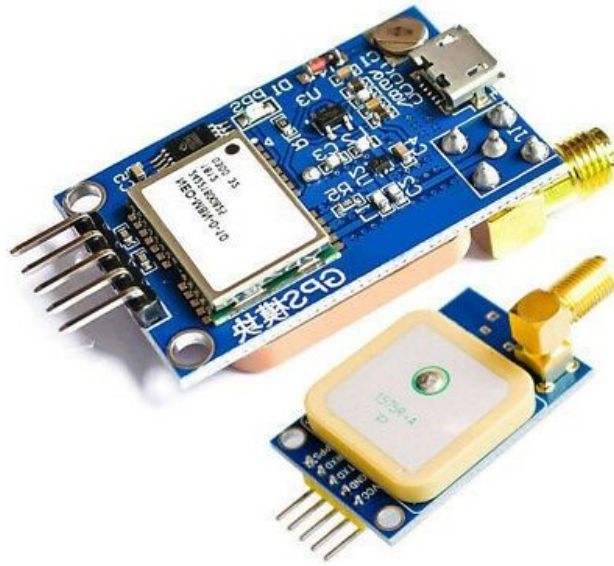
Slika 2.4 GPS U-BLOX NEO-7M
