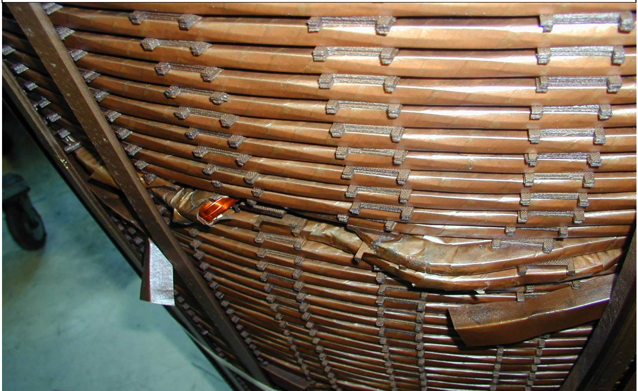
Slika 5. Namoti SN doživjeli su deformacije na mjestima prepleta transponiranih vodiča
