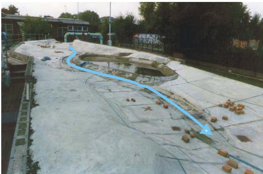
Slika 5.5. Fizikalni model doline rijeke Toce (uzvodni dio)
