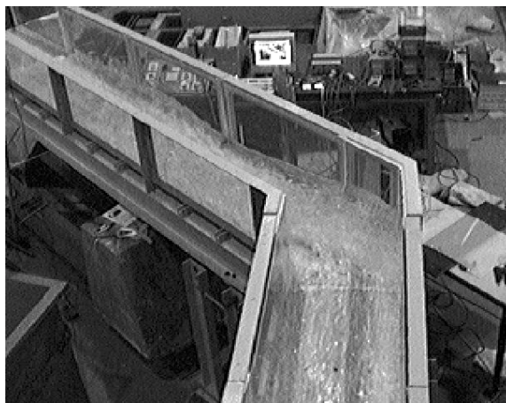
Slika 5.2. Strujanje kroz kanal i reflektirani val koji se formira na pregibu (pogled nizvodno)
