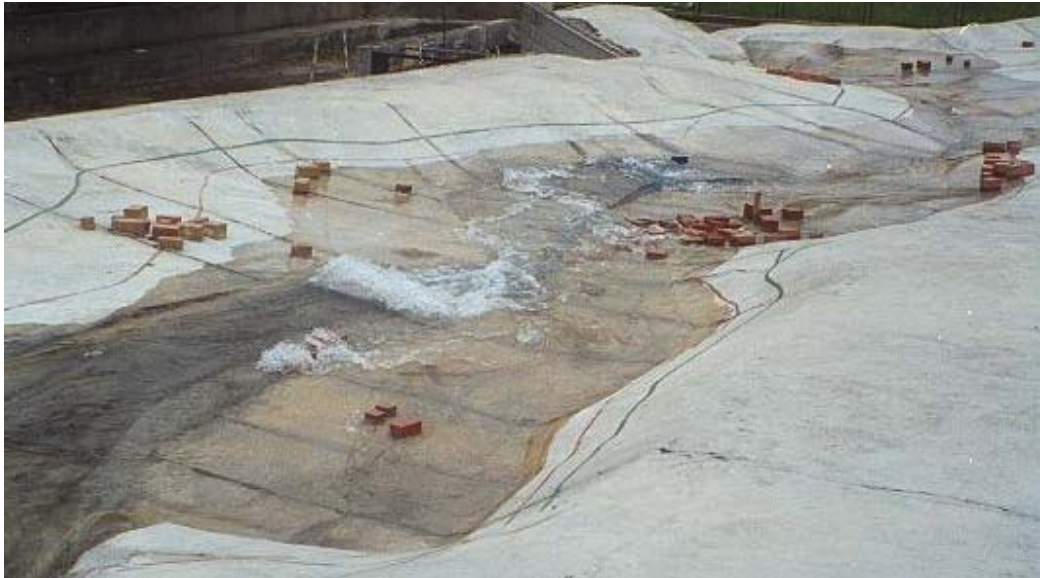
Slika 5.10. Poplavljanje nizvodnog dijela modela, potopljeni most i građevine
