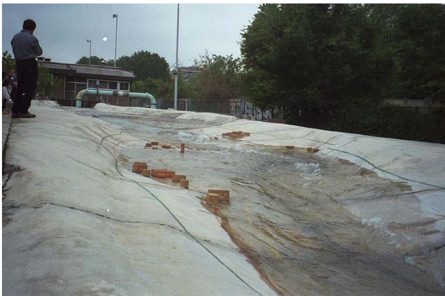
Slika 5.9. Poplavljanje uzvodnog djela modela
