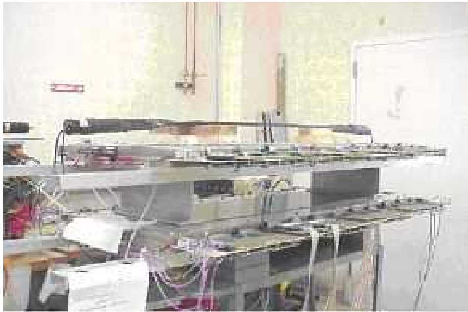
SLIKA 4.1: POSTAV ZA KALIBRACIJU DRIFTNIH KOMORA. KORISTE SE DVIJE DRIFTNE KOMORE, GORNJA JE DRIFTNA KOMORA 2 (DC2) NA NJOJ SE NALAZI SCINTILATOR. DRUGI SCINTILATOR JE SMJEŠTEN ISPOD KOMORE 1 (DC1). SCINTILATORI SU POSTAVLJENI TAKO DA SE NALAZE TOČNO ISPOD, TJ. IZNAD, ODABRANOG PODRUČJA ZA KALIBRACIJU KOMORA. KOINCIDENCIJA SIGNALA SA SCINTILATORA SLUŽI KAO STOP SIGNAL.
