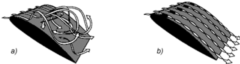
Slika 2. a) nekontrolirano odvajanje strujnica od površine (turbulentno strujanje); b) strujnice ostaju uz površinu zbog djelovanja površinskih generatora vrtloga
