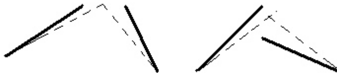
Slika 18. Korigiranje praznina između linearnih elemenata
