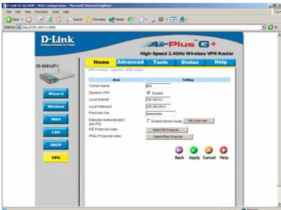
Slika 4.7 Osnovne postavke za dinamički IPSec
