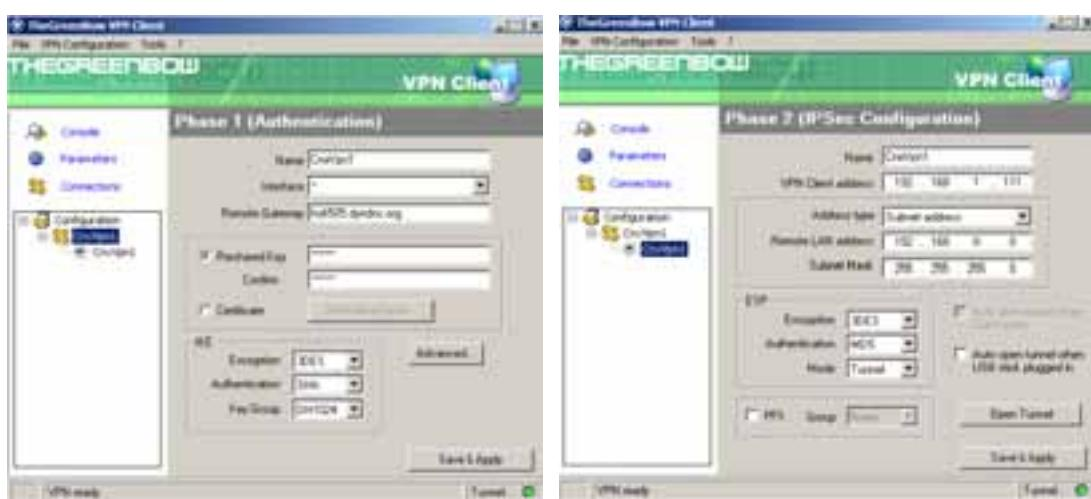
Slika 4.22 Postavke za prvu i drugu fazu za uspostavu IPSec tunela
