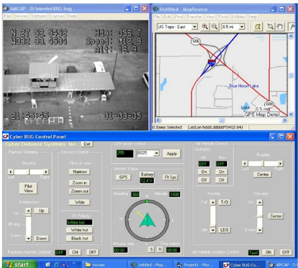
Slika 5.1.3.3. – Upravljačko sučelje sustava bespilotne letjelice
