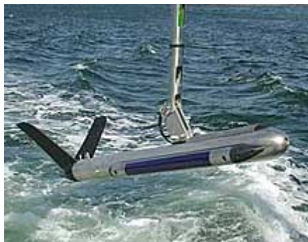
Slika 15. Side scan sonar
