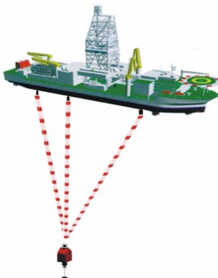
Slika 31. Sustav s kratkom bazom
