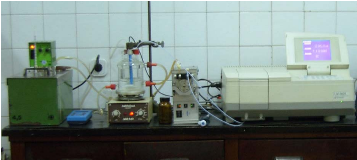
Slika 3.1. Aparatura za provedbu šaržne kristalizacije.
