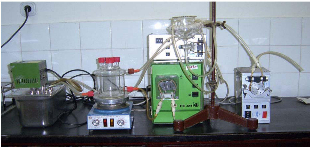
Slika 3.3. Aparatura za provedbu kontinuirane kristalizacije.
