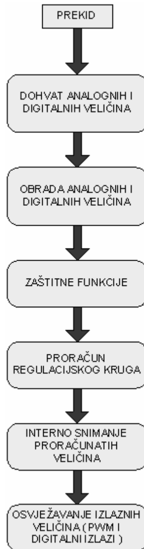
Slika 7.12. Dijagram toka izvođenja prekida
