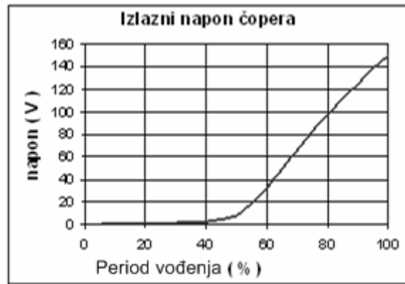
Slika 6.3 Odnos izlaznog napona čopera i perioda vođenja tranzistora
