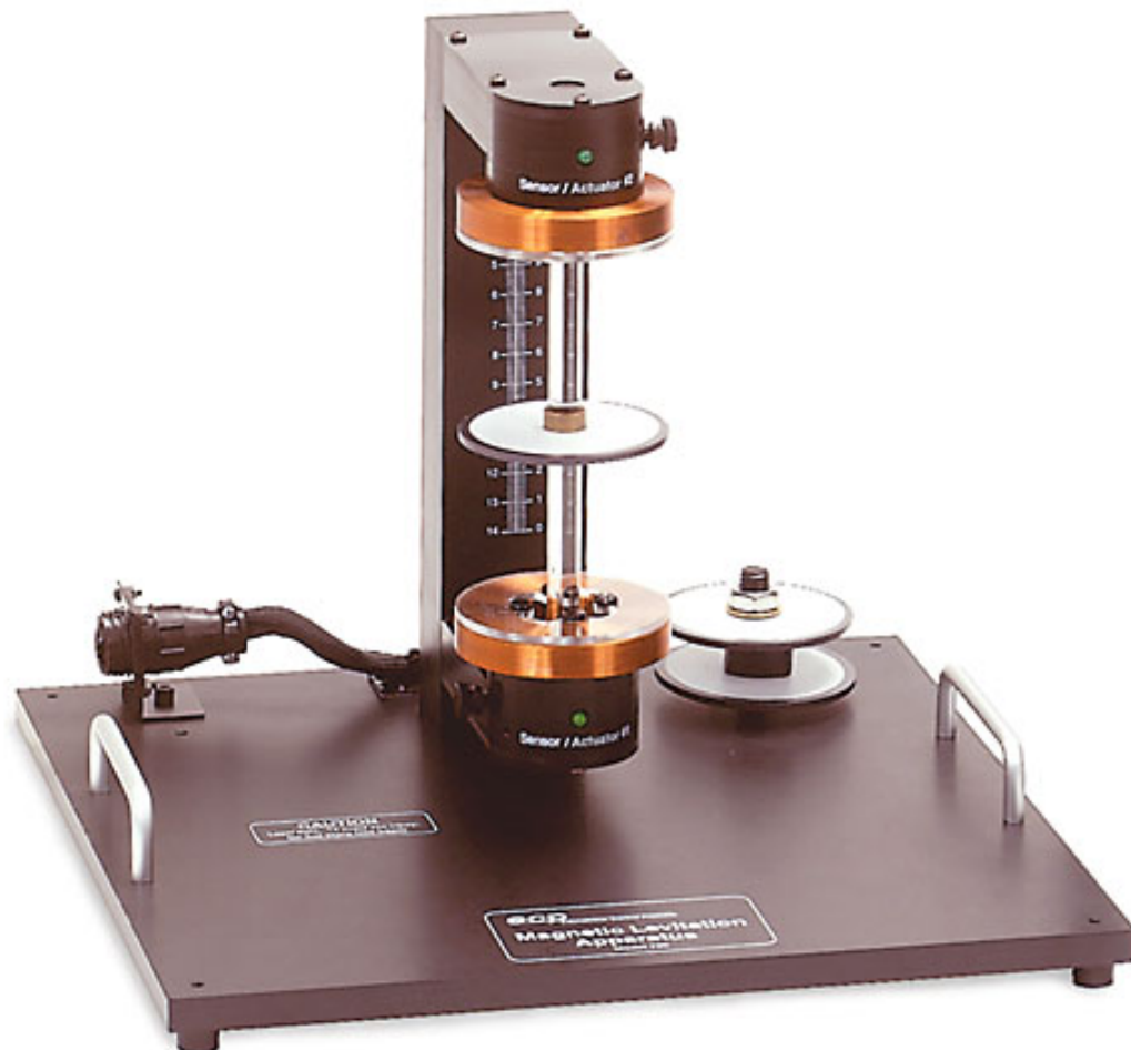
Slika 4.1. Laboratorijski postav procesa magnetske levitacije.
