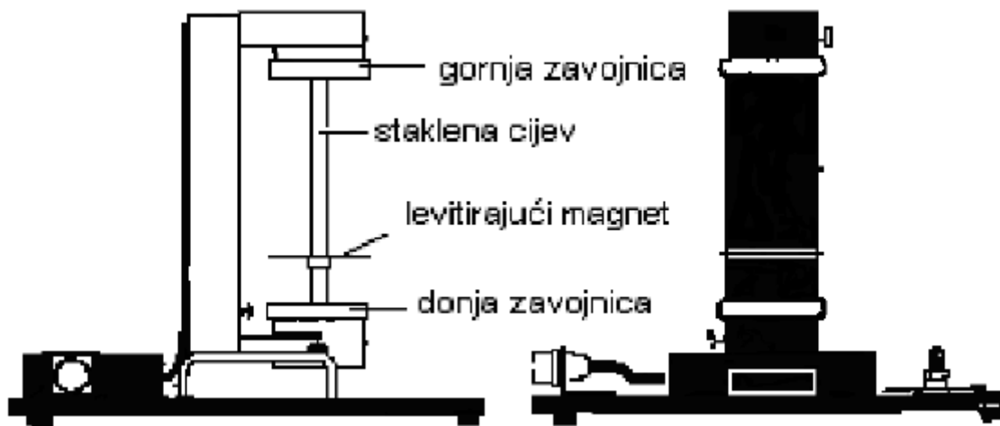
Slika 4.2. Skica laboratorijskog procesa magnetske levitacije.
