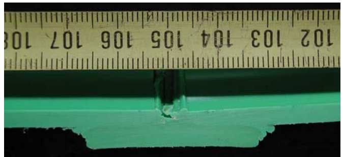
Slika 13. Snimak uzdužnog presjeka nauljene epruvete zavarene preporučenim parametrima [2] Figure 13. Picture of longitudinal cross-section of oiled specimen welded on recommended parameters [2]
