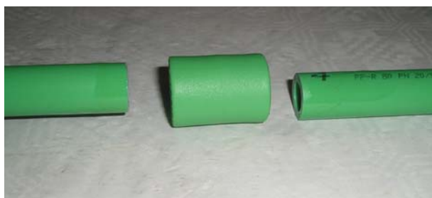
Slika 7. Prikaz pripremljenih dijelova za spajanje zavarivanjem [2]
