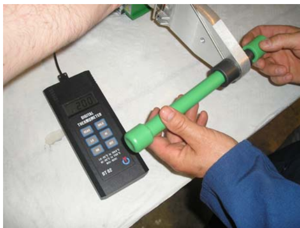
Slika 9. Zavarivanje pri temperaturi vrućeg elementa od 200 °C i vremenu zagrijavanja od 5 sekundi [2]
