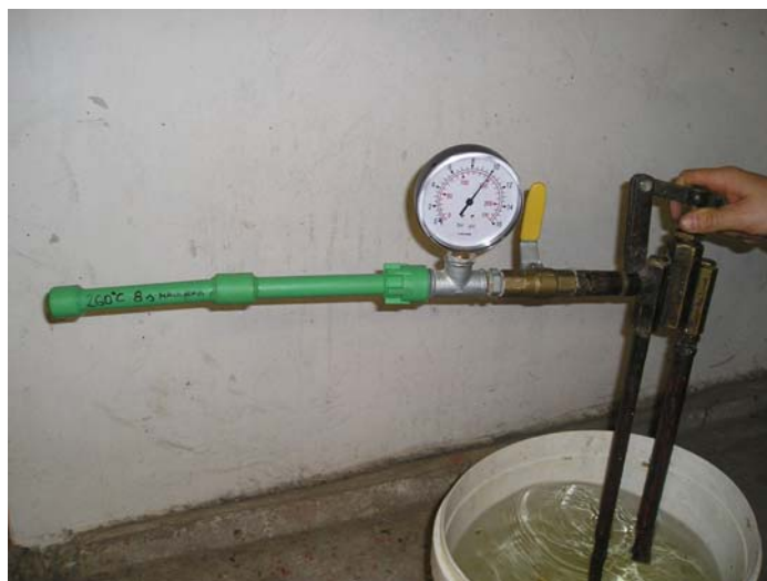
Slika 11. Tlačno ispitivanje pripremljenog ispitnog tijela ručnom tlačnom pumpom [2]
