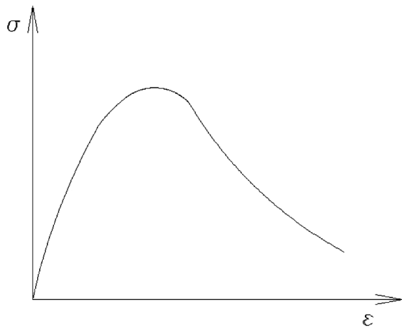
Slika 4 Izgled krivulje \sigma - \varepsilon za slom putem gredno – štapnog izvijanja Figure 4 Load – end shortening curve \sigma - \varepsilon for beam column buckling
