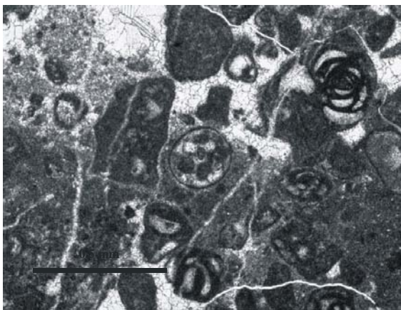
Slika 10.10. Neposredna podina drugog glinovitog horizonta s profila Lakovići-sjever (izbrusak L2-2P). Biointrasparit do biointramikrit s različitim međusobnim udjelima alokema mikrita i sparitnoga cementa.
