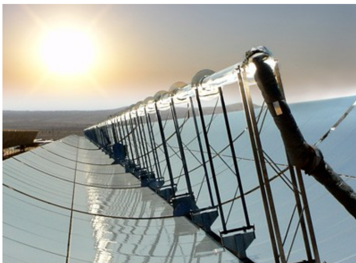
Slika 4. Parabolična cilindrična zrcala koncentriraju sunčevo zračenje na cijev u žarištu
