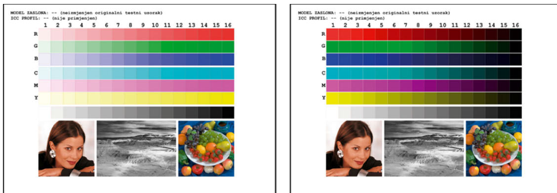
Slika 4. Testne forme s nizovima mjernih polja
