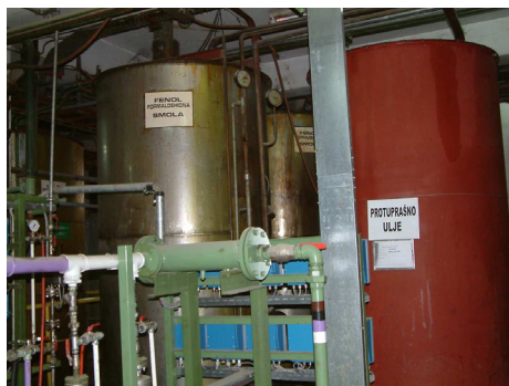
Slika 5. Zatvoreni spremnici komponenata veziva
