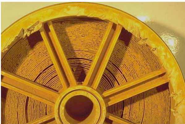
Slika 6. Željezni oksid među slojevima namota membrane [1]
