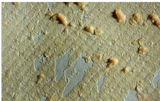
Slika 5. Pojava biofilma na površini membrane [1]
