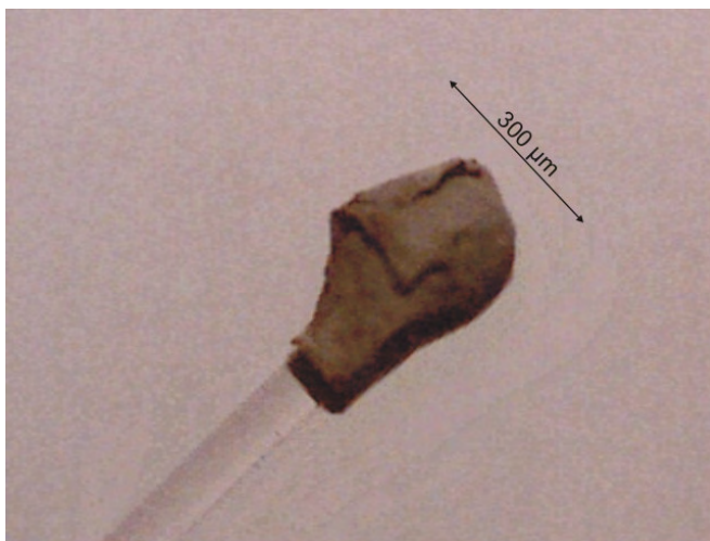
Slika 2.3 : Vrh optičke katalitičke sonde, snimljen mikroskopom sa povećanjem od 60 puta, nakon mjerenja.
