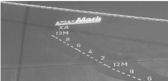
Figure 2. The *CroMark* draft marks aft on m/t «Stinice»
