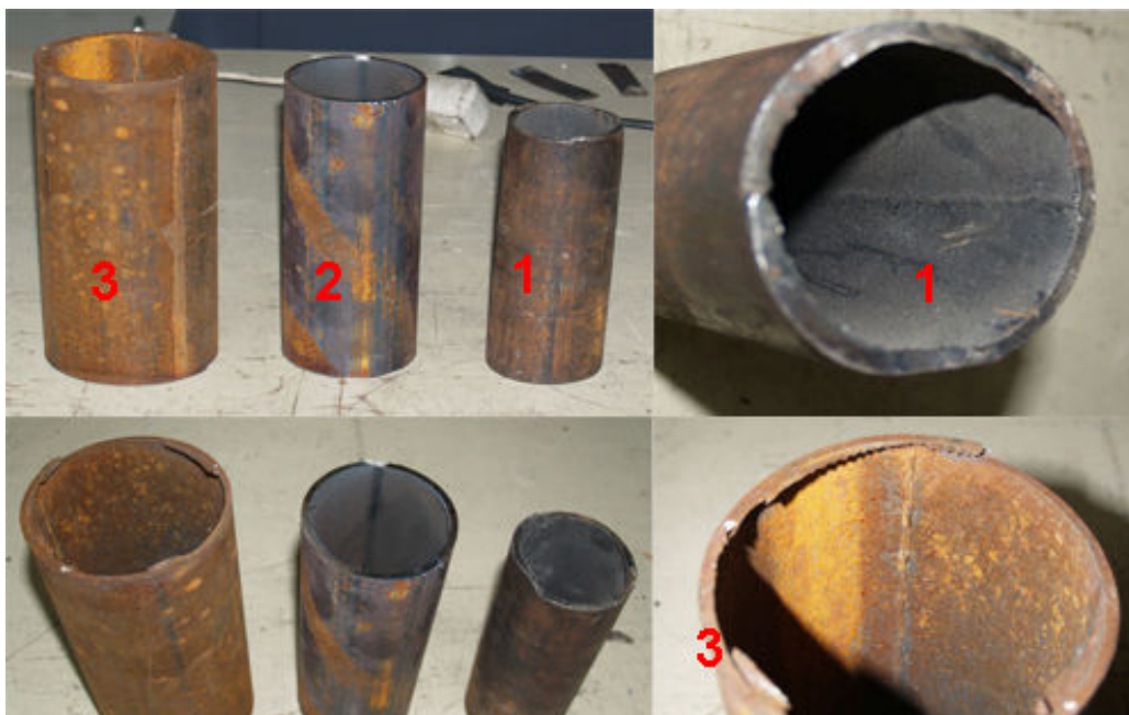
Slika 1.2. Testni uzorci šavnih cijevi od konstrukcijskog čelika
