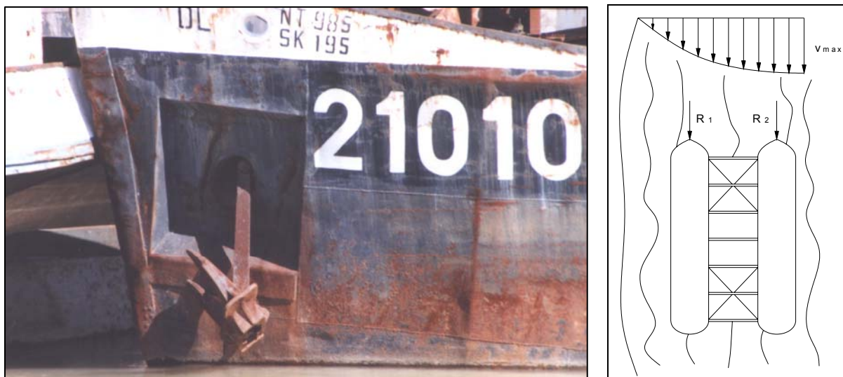
Slika 12. Postojeći sidreni uređaji (lijevo), Nesimetrična uzdužna opterećenja u riječnoj struji (desno)
