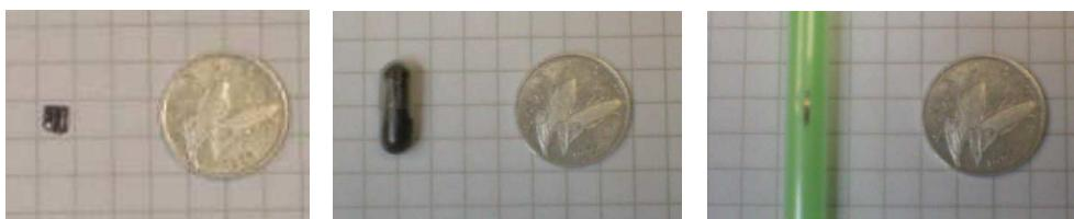
*Slika 5.3: Uzorci pripremljeni za magnetsko mjerjenje. Lijevo je monokristal Mn<sub>12</sub>-acetata na silicijevoj pločici, u sredini magnetske nanočestice s parafinom u ampuli, a desno Hf-Fe slitina na slamci. U pozadini je kvadratna mreža od 5mm.*
