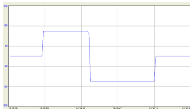
Sl. 12. Oscilogram izmjerene brzine vrtnje pri stvarnoj brzini vrtnje 150 \text{ min}^{-1}
