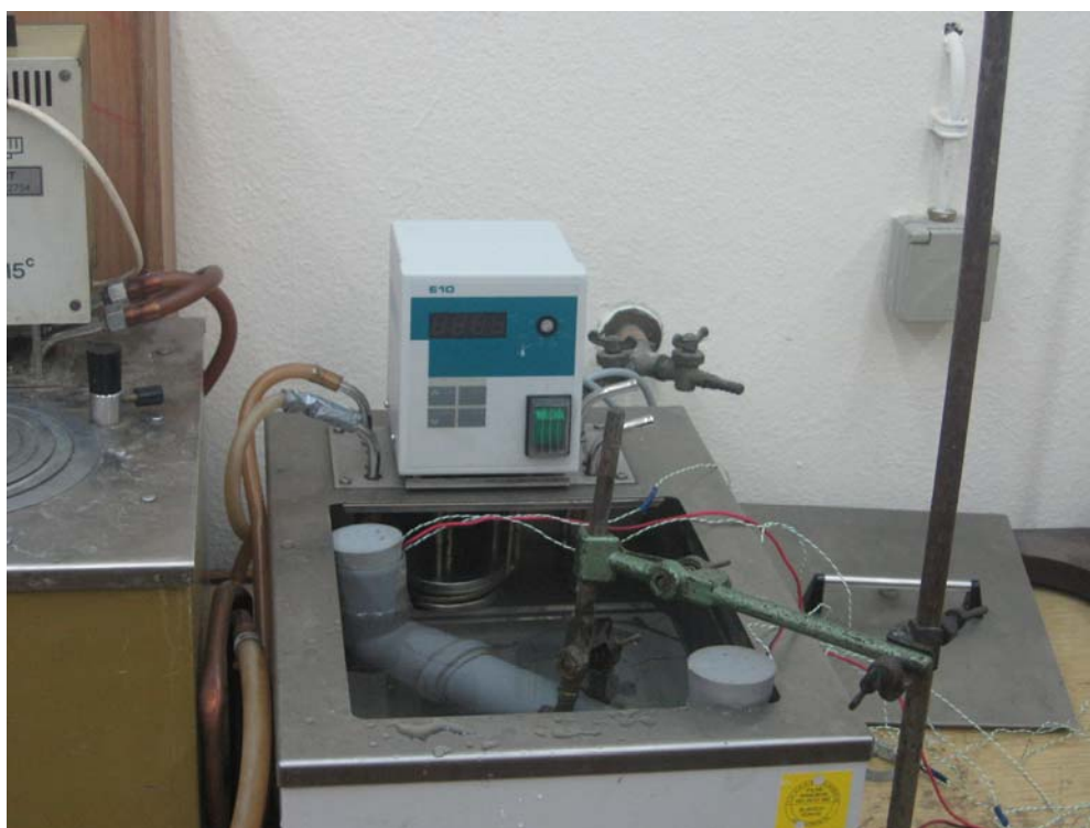
Slika 3. Eksperimentalni postav mjerenja toplinske difuzivnosti materijala.
