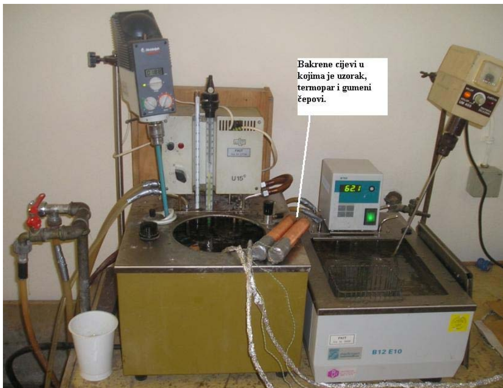
Slika 9. Dvije vodene kupelji kojima se određuje toplinska difuzivnost
