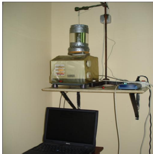
Slika 12. Aparatura za mjerenje gustoće tekućeg, vrućeg parafina
