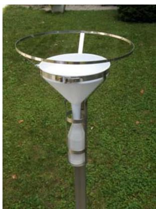
Slika 2. *Bulk sampler*, oprema za prikupljanje mokrog i suhog taloga, na postaji Zagreb Grič (Foto: O. Perčinić, 2008.)
