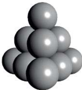
Slika 6.2: Romboedarsko slaganje idealnih kugli mineralnih zrna (preuzeto s: http://www.glossary.oilfield.slb.com/DisplayImage.cfm?ID=167 )
