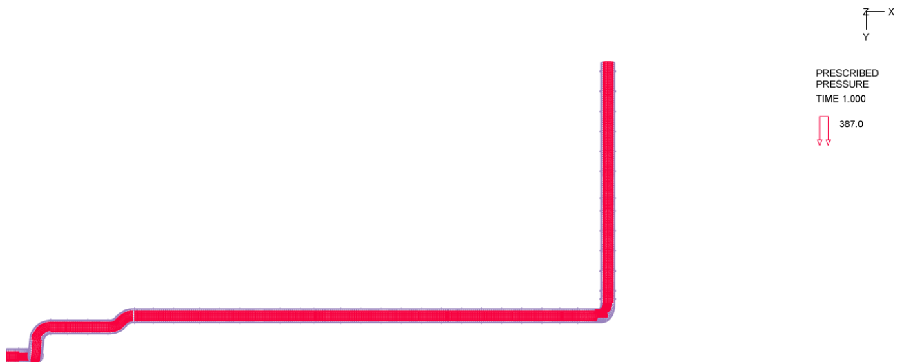
Opterećenje cjevovoda uslijed pritiska prašine (prikaz u ravnini x-y)
