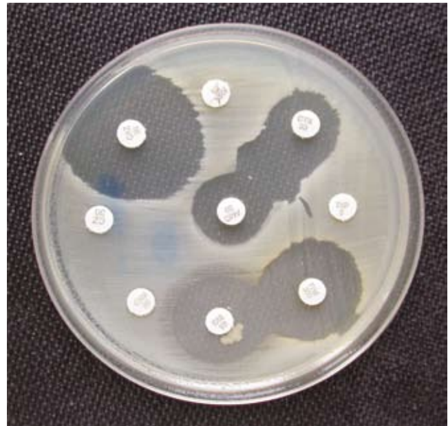
Slika 15.6. Dvostruki disk-sinergistički test: soj je pozitivan na produkciju \beta -laktamaza proširenog spektra. Vidljivo je proširenje inhibicijske zone oko diska ceftriaksona, cefoperazona i cefotaksima prema centralnom disku koji sadrži klavulansku kiselinu (Izvor: iz vlastite zbirke, B. Bedenić, 2005.)
