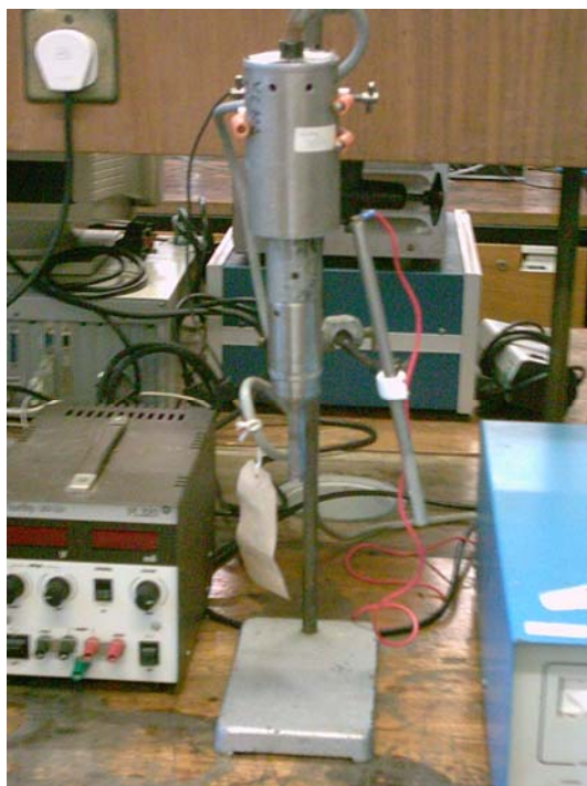
Slika 21. Ultrazvučni postav sa sondom od 20 kHz
