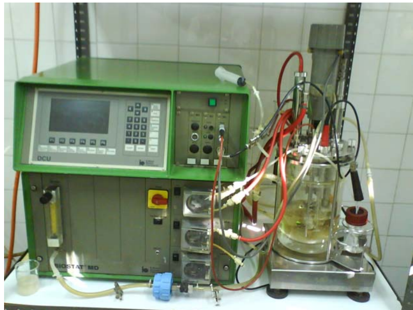
Slika 3.7. Proces proizvodnje lakaze u bioreaktoru
