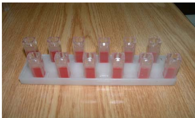
Slika 3.4. Kinonimin nastao spektrofotometrijskm određivanjem koncentracije glukoze PAP metodom
