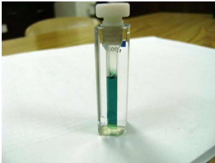
Slika 3.3. Obojenje nastalo oksidacijom ABTS-a lakazom
