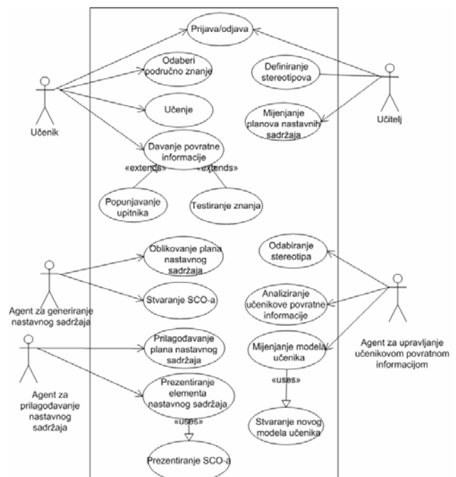
Slika 2. Dijagram slučajeva korištenja modela sustava za inteligentno generiranje računalom oblikovanih nastavnih sadržaja
