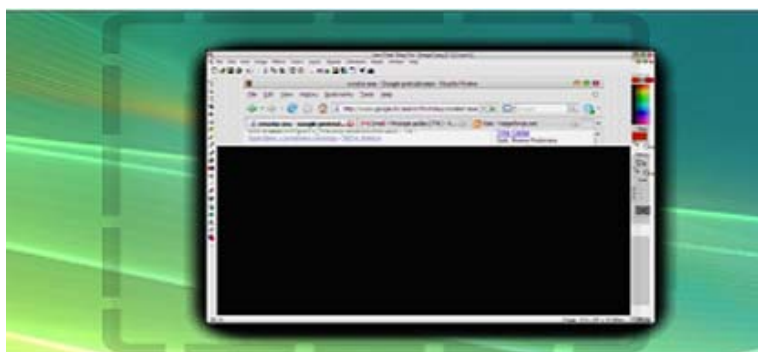
Slika 3.6 Slika sa crnim područjima zbog greške u funkciji PrintWindow
