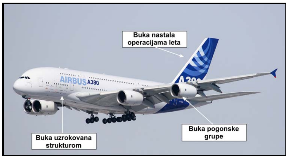
Slika 3. Izvori buke na zrakoplovu
