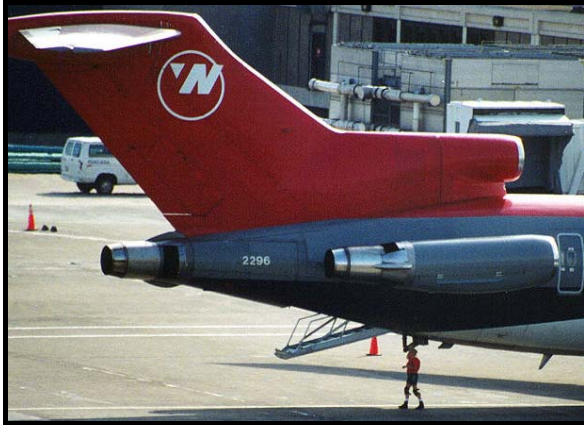
Slika 73. Prikaz hush kit sustava ugrađenih na zrakoplovima tipa Boeing 727
