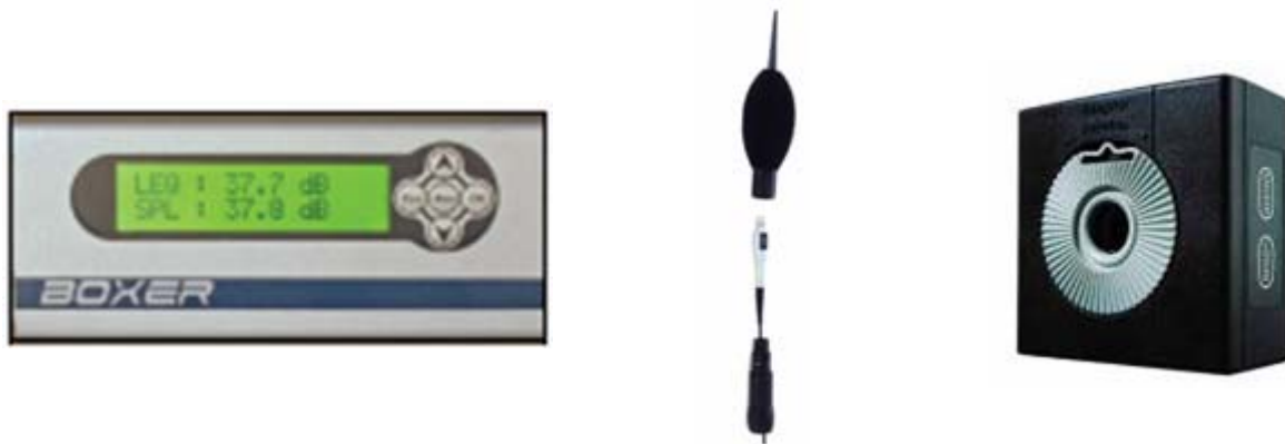
Slika 38. Prikaz analizatora zvuka, mikrofona i kalibratora
