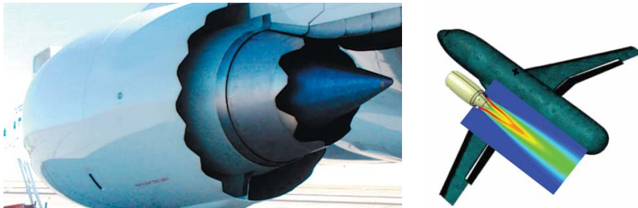
Slika 71. Prikaz mlaznice za redukciju buke
