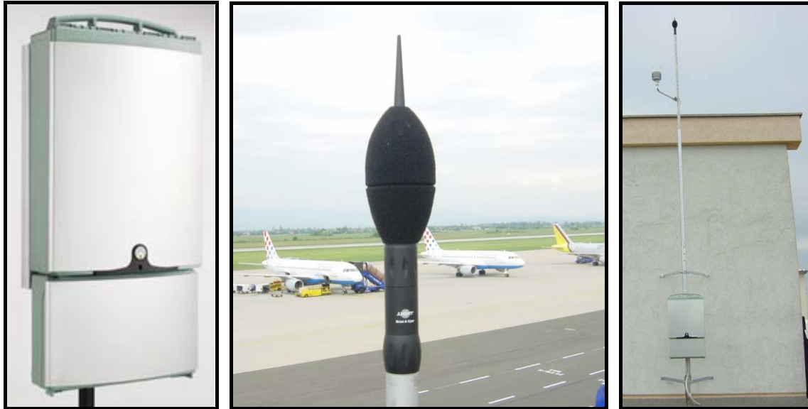
Slika 37. NMT (Noise Monitoring Terminal) stanica sa mikrofonom
