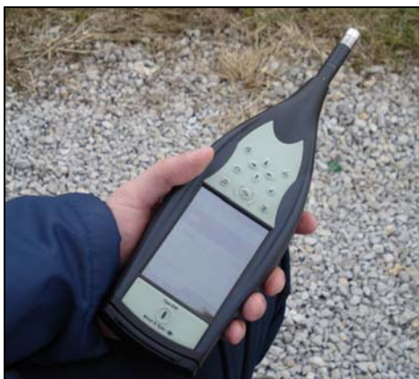
Slika 51. Mobilna stanica za mjerenje buke zrakoplova Type 2250
