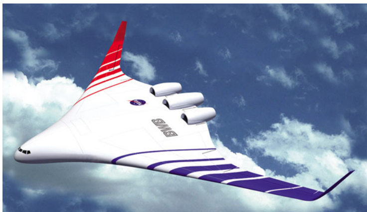
Slika 81. Računalni prikaz BWB zrakoplova i odnos veličine BWB zrakoplova sa Boeing 747
