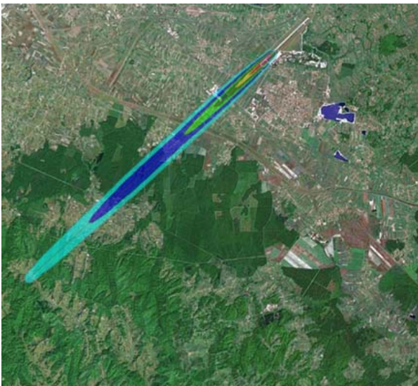
Slika 94. Simulacija odnosa konvencionalnog (step down) i CDA prilaza izrađena na INM sustavu Zračne luke Zagreb
