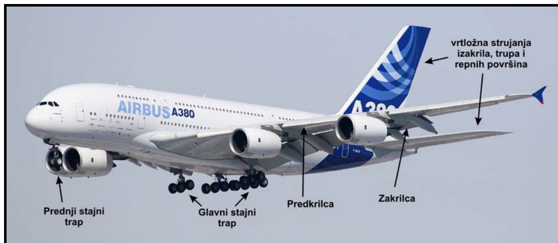
Slika 6. Prikaz izvora buke koju stvara struktura zrakoplova
