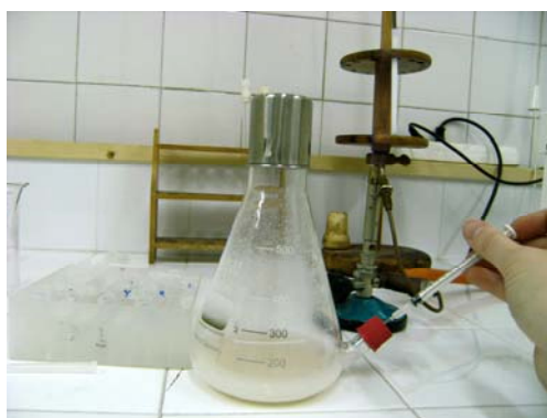
Slika 3.5. Postupak sterilnog uzimanja uzoraka
