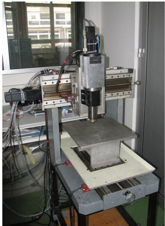
Figure 6. 3-axis mini milling machine
