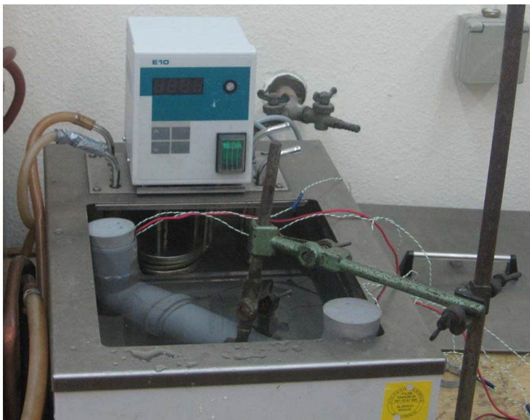
Slika 17. Eksperimentalni postav pri mjerenju toplinske vodljivosti materijala metodom vruće žice.
