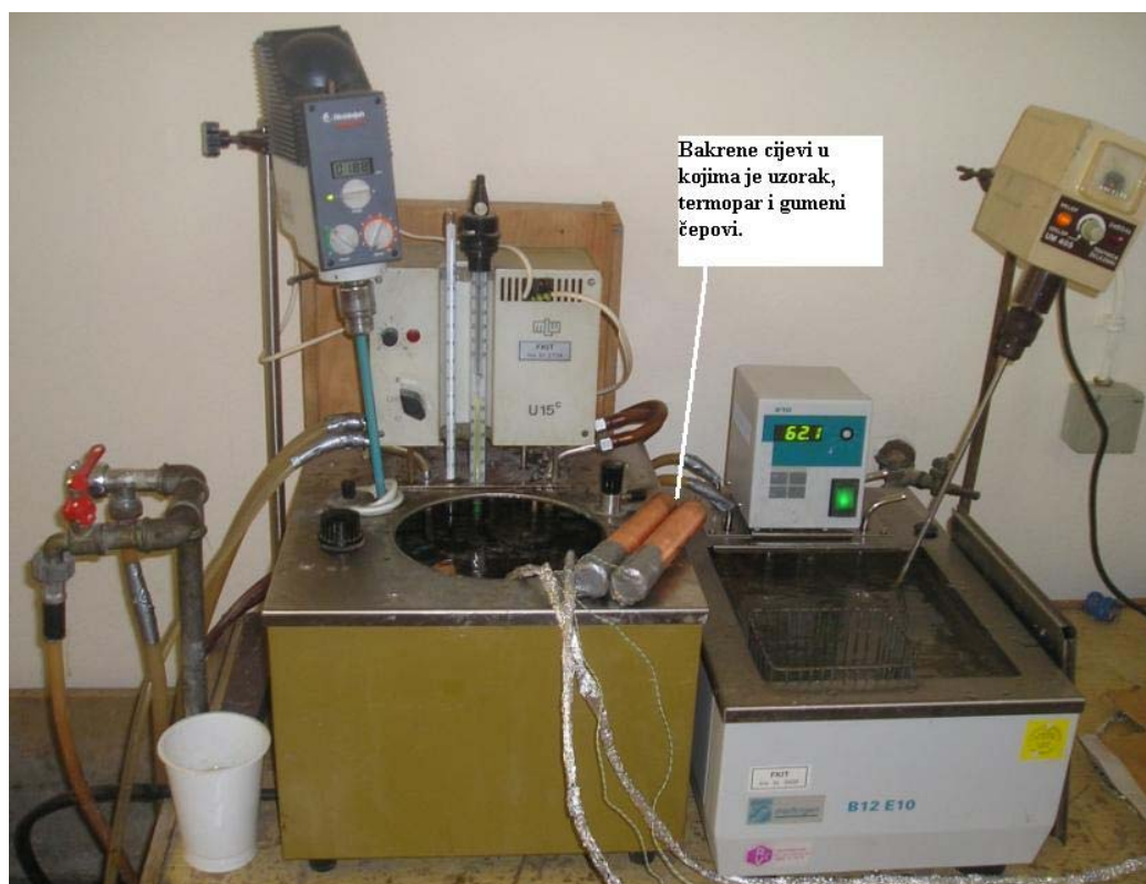
Slika 16. Dvije vodene kupelji uporabljene za mjerenje toplinske difuzivnosti.
