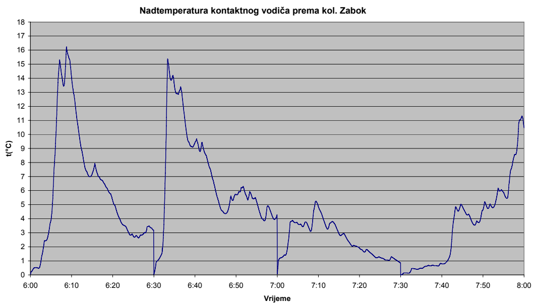
Slika 5.28. Nadtemperatura kontaktnog voda prema kol. Zabok
