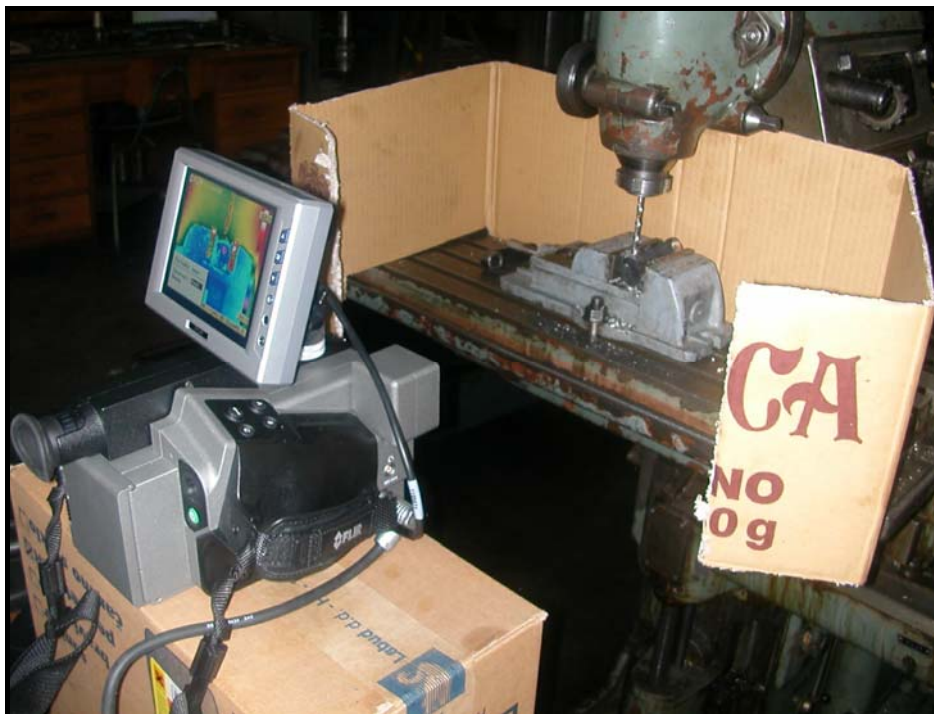
Slika 36. Snimanje procesa bušenja kosti termovizijskom kamerom
