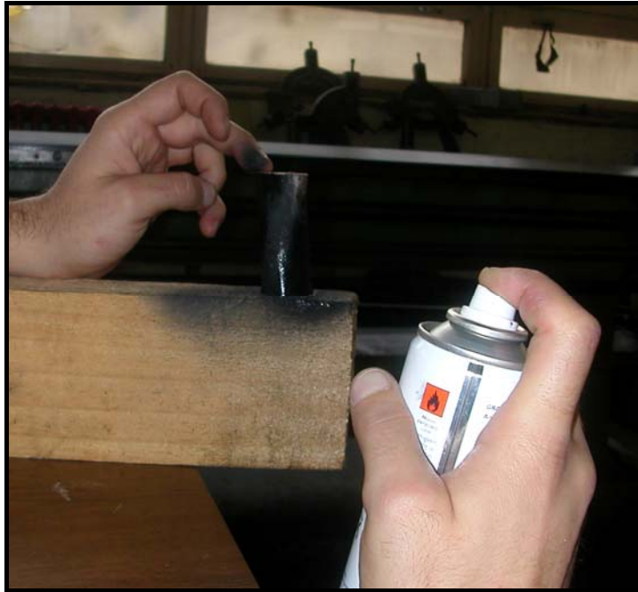
Slika 35. Ravnomjerno nanošenje sloja grafita na očišćenu površinu kosti
